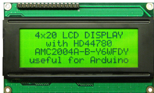
Een LCD display met 4 regels van 20 karakters
