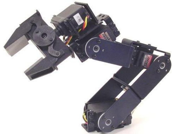
Een robotarm met 5 servo's
